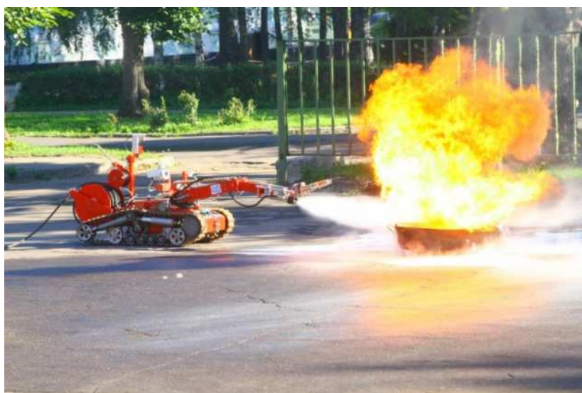
Рисунок 76. Тушение очага пожара роботом МРК-РП
